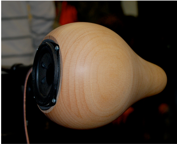
Zu vermessender Tropfenlautsprecher und Vorverstärker mit MADI Interface
