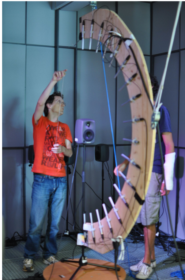
Abbildung 2: Messaufbau für die Abstrahlcharakteristikmessung
