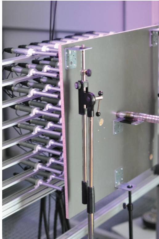
Abbildung 10: Anbringung der Punktschallquelle.
