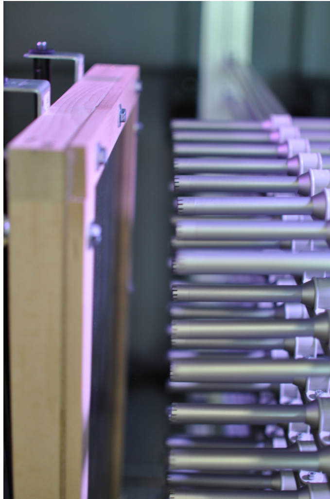
Abbildung 7: 8x8 Mikrofonarray mit schwingender Platte
