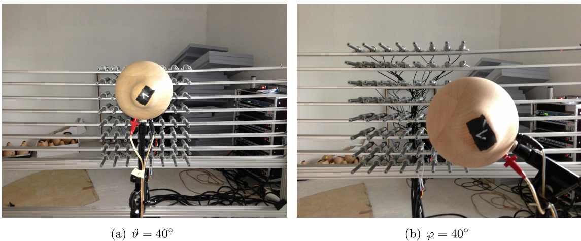
Abbildung 3.1: Lautsprecherpositionen für die Direktfeldmessungen
