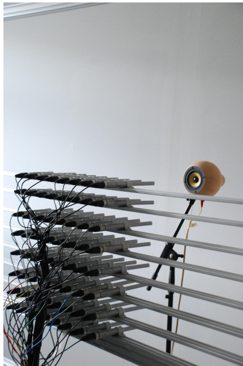
Abbildung 2.1: IEM-Tropfenlautsprecher und 64-Kanal Mikrophonarray
