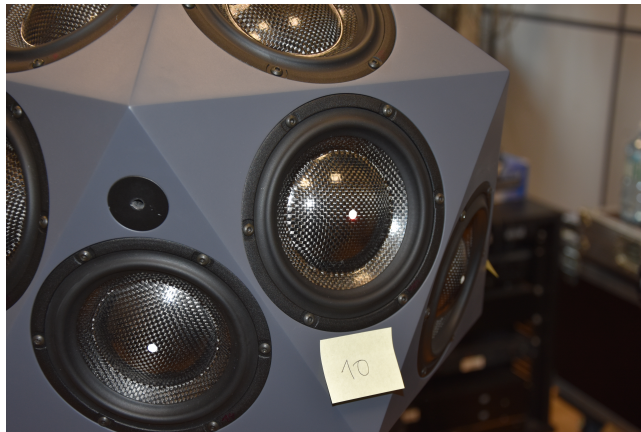
Abbildung 3.5 – Reflektierender Punkt inmitten der Membran.
