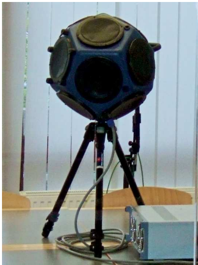
(a) Omnidirektionale Schallquelle für gewöhnliche Messmethode.
