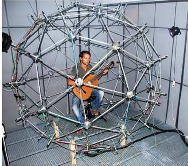
Abbildung 29 – Kugelförmige Mikrofonanordnung zur Messung der Schallabstrahlung.
