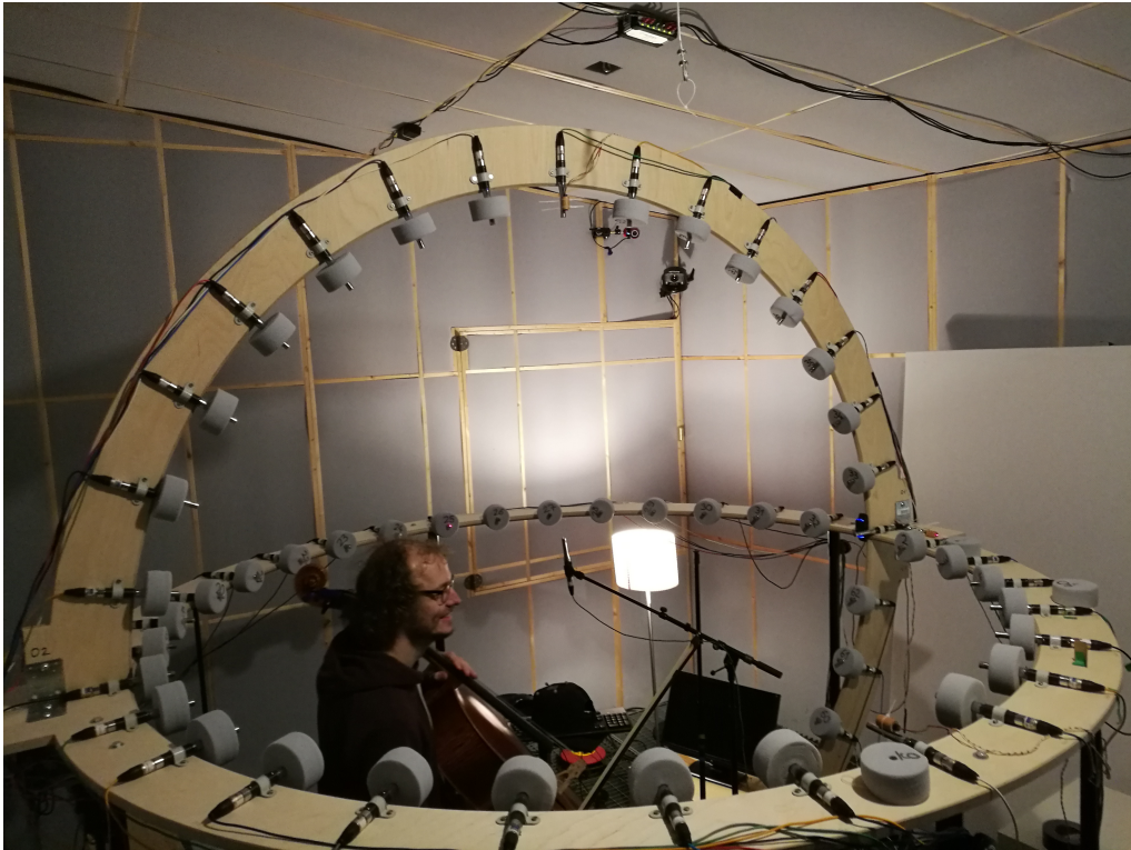
Abbildung 5: Aufbau zur Vermessung eines Violoncellos
